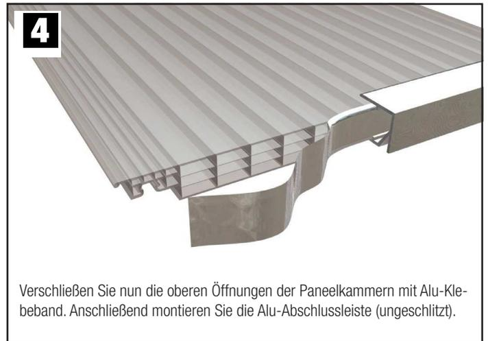
Verschließen Sie nun die oberen Öffnungen der Paneelkammern mit Alu-Klebeband. Anschließend montieren Sie die Alu-Abschlussleiste (ungeschlitzt).
