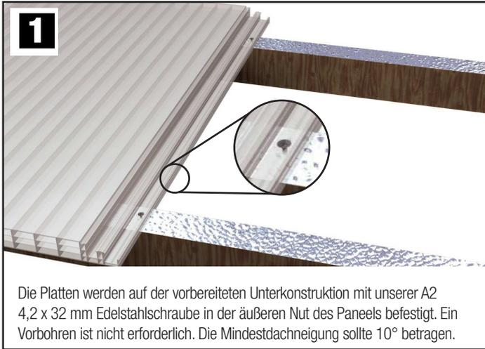
Die Platten werden auf der vorbereiteten Unterkonstruktion mit unserer A2 4,2 x 32 mm Edelstahlschraube in der äußeren Nut des Paneels befestigt. Ein Vorbohren ist nicht erforderlich. Die Mindestdachneigung sollte 10° betragen.
