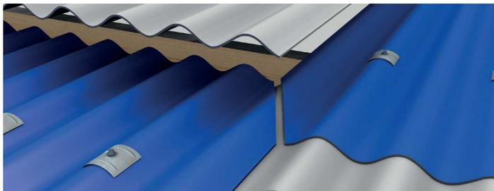
Um vierfach Überlappungen an den zueinander laufenden Ecken zu vermeiden, werden die Ecken der beiden mittleren Platten abgeschnitten. Zwischen den Eck-schnittkanten sollte ein Freiraum von 10 mm gelassen werden.
